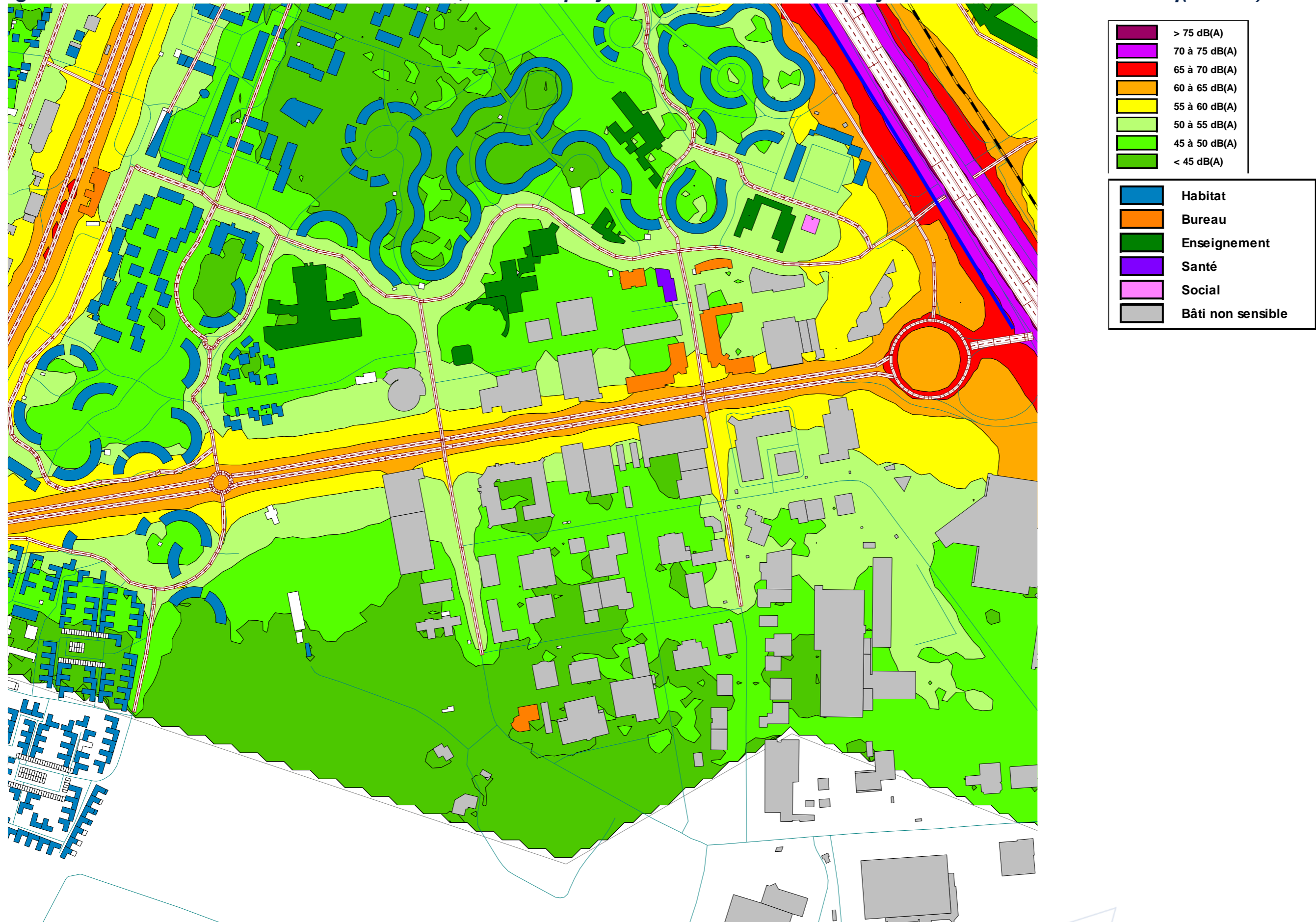
Figure 15. Carte de bruit à 4 mètres de hauteur, situation projet à l'horizon 2025 sans projets connexes indicateur LAeq(22h-6h) – Secteur 1
