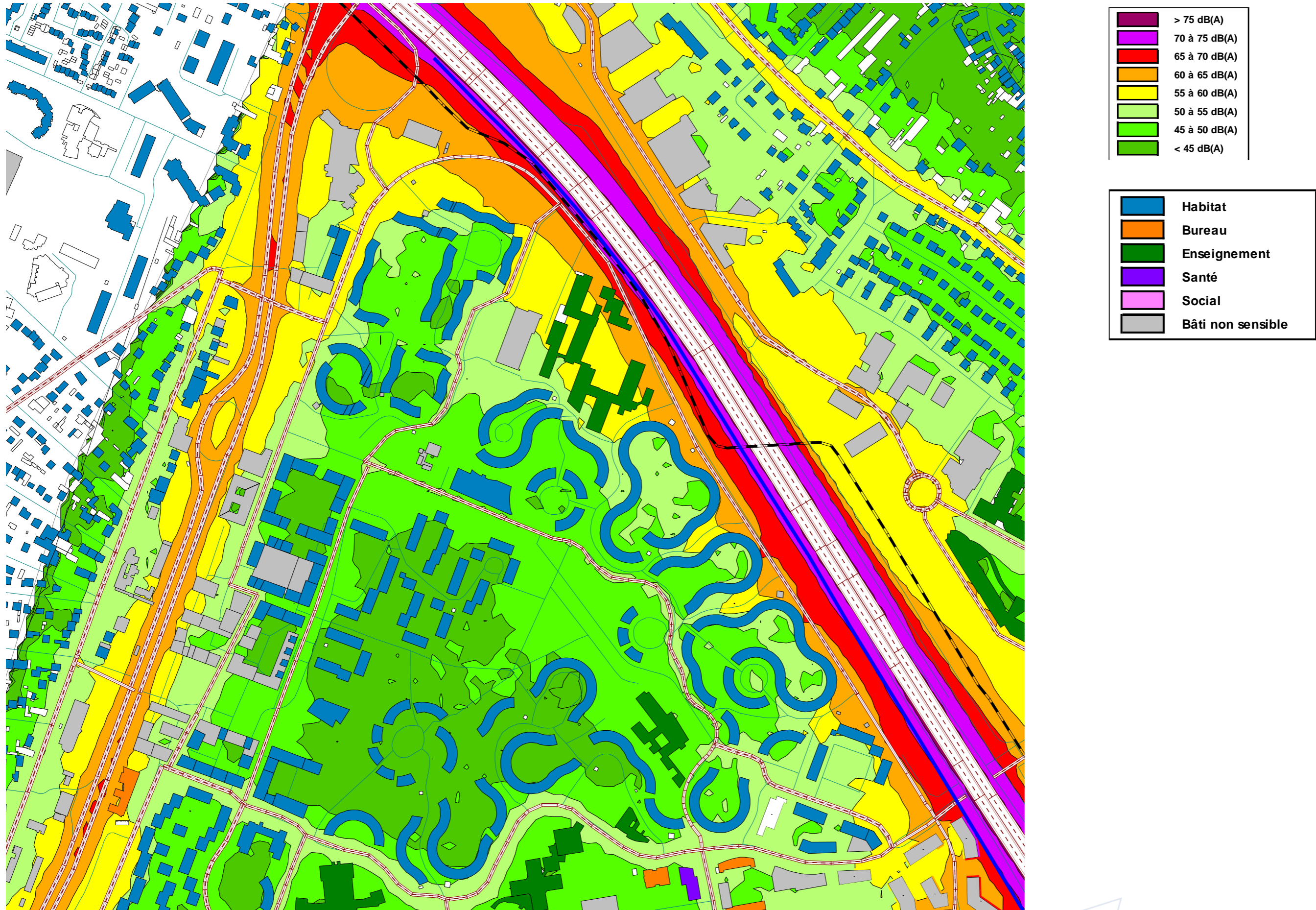
Figure 36. Carte de bruit à 4 mètres de hauteur, situation projet à l'horizon 2035 et projets connexes indicateur LAeq(22h-6h) – Secteur 1
