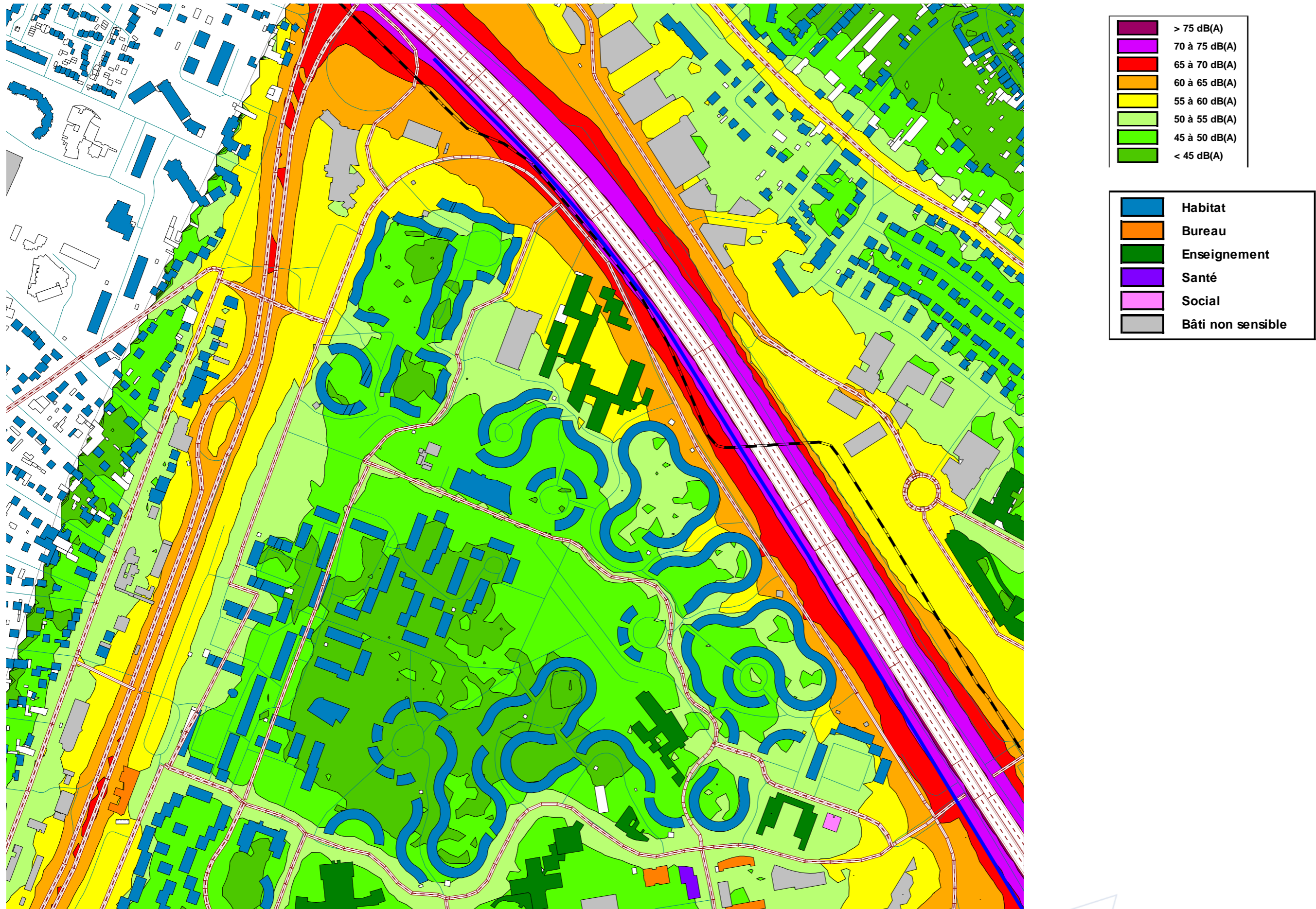
Figure 22. Carte de bruit à 4 mètres de hauteur, situation projet à l'horizon 2025 avec projets connexes indicateur LAeq(22h-6h) – Secteur 1
