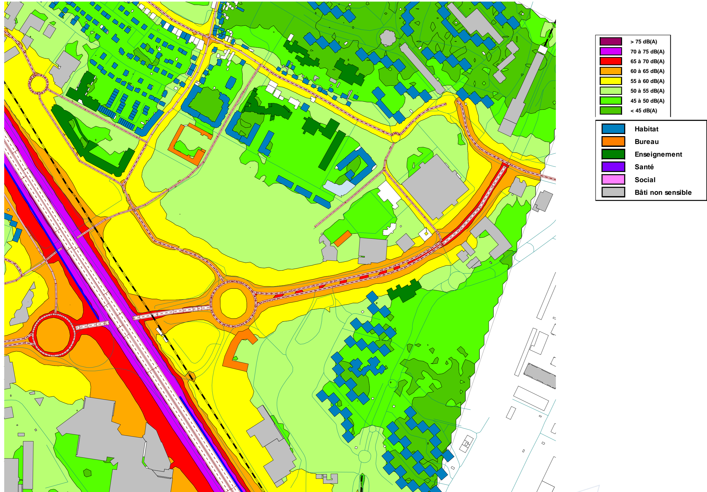
Figure 16. Carte de bruit à 4 mètres de hauteur, situation projet à l'horizon 2025 sans projets connexes indicateur LAeq(22h-6h) – Secteur 2
