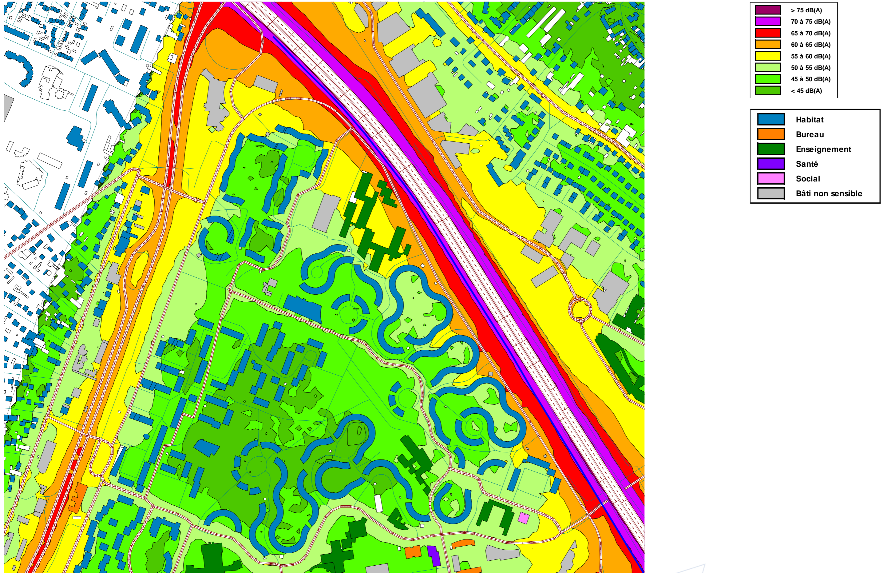
Figure 6. Carte de bruit à 4 mètres de hauteur en situation initiale pour l'indicateur LAeq(22h-6h) – Secteur 1
